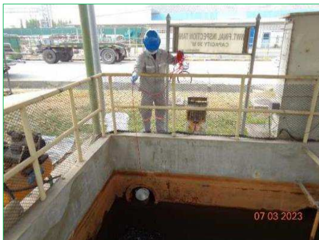
ภาพที่ 3.29 การตรวจวัดคุณภาพน้ำบ่อบำบัดน้ำทิ้งก่อนระบายออกนอกโครงการ (Final Inspection Tank)
