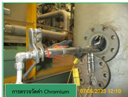
ภาพที่ 3.5 การตรวจวัดคุณภาพอากาศจากปล่อง EPL Chemical (สายผลิตที่ 1)
